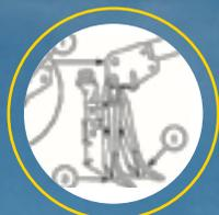
A haste com regulagem de ataque proporciona a adequação do trabalho de abertura do sulco de adubo de acordo com a necessidade do produtor.
