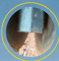
Associado ao distribuidor, temos o condutor curvo e recuado, que trabalha com a função de rampa, evitando os desvios da trajetória das sementes e garantido a sua perfeita colocação no sulco de plantio.
