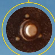
O uso de rolamentos blindados e buchas autolubrificadas evita a utilização de bicos de graxa, reduzindo a possibilidade de contaminação do lubrificante e aumentando a vida útil dos componentes.
