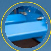
Chassi modular reforçado, com travessas inclinadas, para evitar o acúmulo de adubo, que promove a corrosão.
